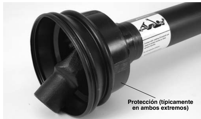
Figura 9 – Protección en el eje de transmisión 840A y advertencia
