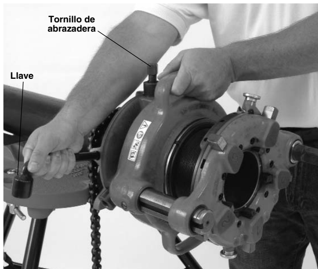
Figura 6 – Cómo apretar el portaherramientas
