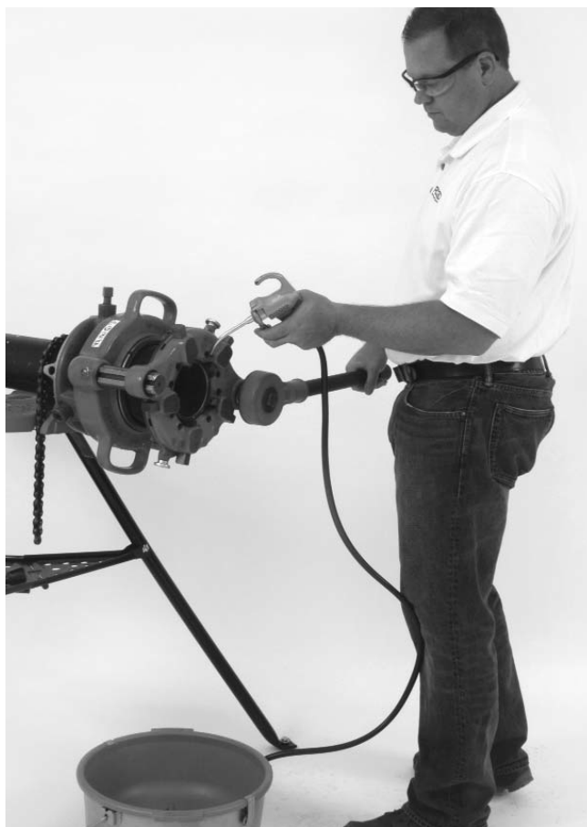
Figura 7 – Funcionamiento con el trinquete D-1440
