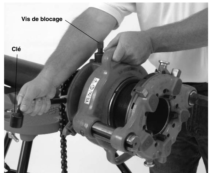
Figure 6 – Serrage de la bride de maintien
