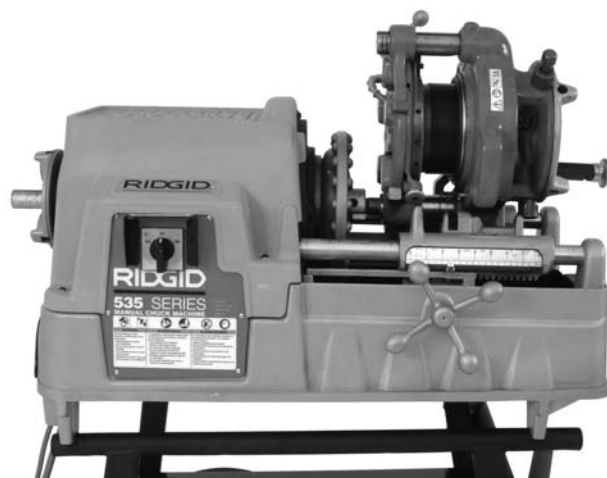
Figure 17 – Fileteuse démultipliée en montage direct avec 535
