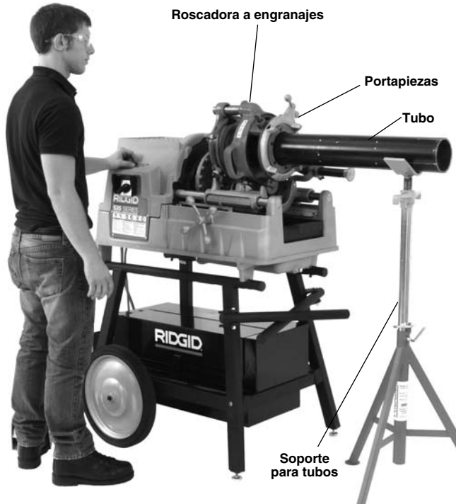
Figura 21 – Posición de operación (método de acoplamiento directo)
